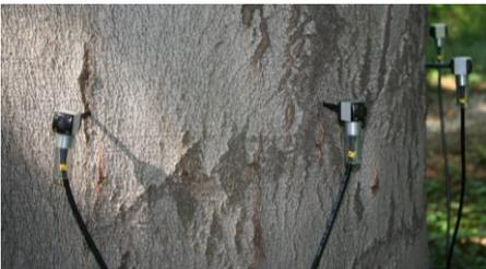
Il TOMOGRAFO ACUSTICO FAKOPP 3D sfrutta le proprietà della diffusione del suono nel legno per produrre una "fotografia" dell'interno dei tronchi, un'immagine che riporta le parti di legno sano, le cavità ma anche le porzioni di legno in corso di degradazione che ancora potrebbero apparire sane alla vista diretta. E' **un'analisi semplice e veloce** che produce solo dei piccoli forellini (4-5 mm) alla corteccia esterna e **non danneggia il legno**.
